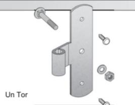
Deux pentures avec chacune boulon 8 x 60 mm. Écrou, rondelle, deux vis à tête ronde 6 x 30 mm et deux capuchons.
