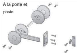
Mécanisme de verrouillage.
